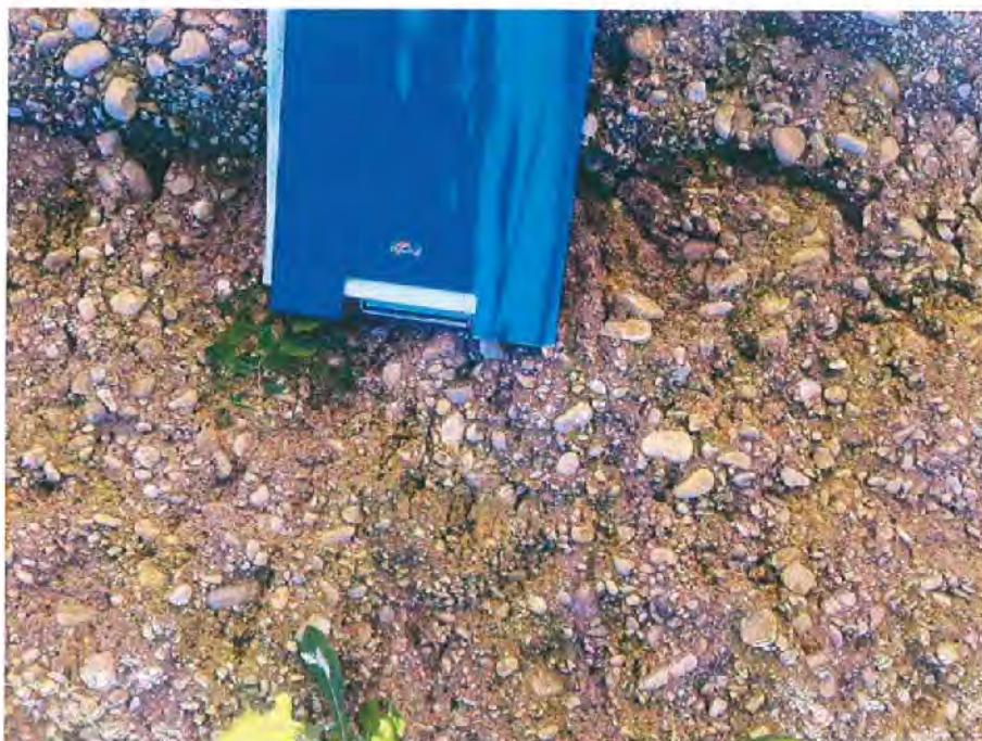
Figura 28 – Poco a sud della zona di confluenza F. Gizio - F. Sagittario (348 m s.l.m.): deposito incoerente costituito da ghiaie in assetto caotico, con elementi prevalentemente calcarei da ben arrotondati a subarrotondati, di dimensioni da centimetriche e decimetriche, immersi in matrice sabbioso-limosa brunastra.
