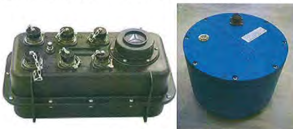
Figura 13 - A sinistra l'acquisitore Reftek-130, a destra il sismometro Lennartz-5s.
